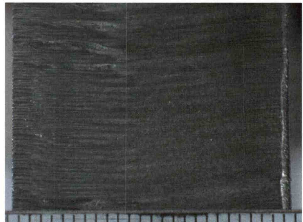
Abbildung 3 Schnittqualität der Probe am bogenförmigen Schnitt
