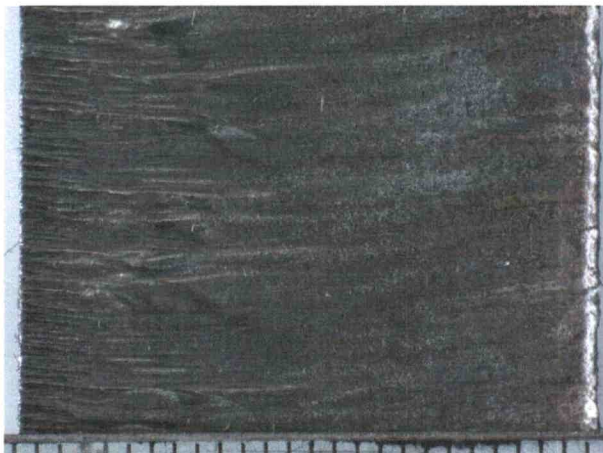
Abbildung 2 Schnittqualität der Probe am geraden Schnitt
