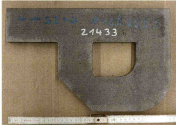
Abbildung 1 Ansicht der Probe mit geradem Schnitt, scharfkantige Ecke und kurvenförmigem Bogen entsprechend DIN EN 1090-2:2018-09 Abschnitt 6.4.3
